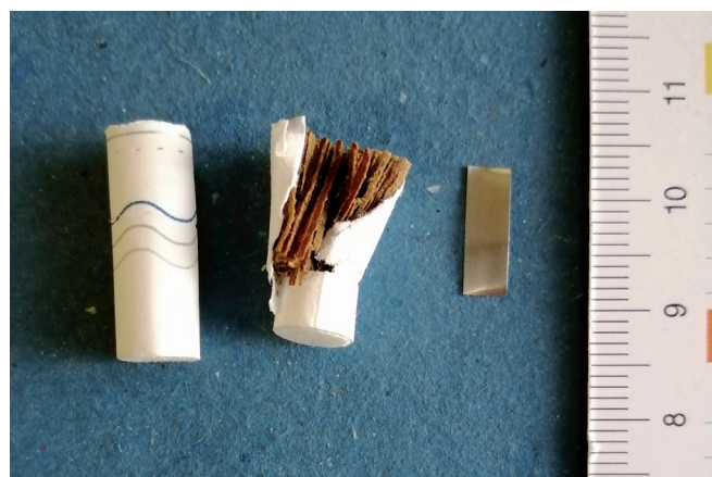
Figura 2. Stick per tabacco scaldato TEREA® analogo a quello ingerito. Da sinistra a destra: filtro, cartuccia di tabacco, lamina metallica radiopaca.
